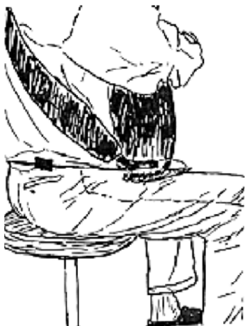
Abb. 12 Stabilizer -Befestigung und Bandbefestigung am Gitarrenendknopf (oder alternativ an einem fest sitzenden Saugnapf)
